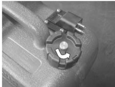
Tanque de Combustible Externo
